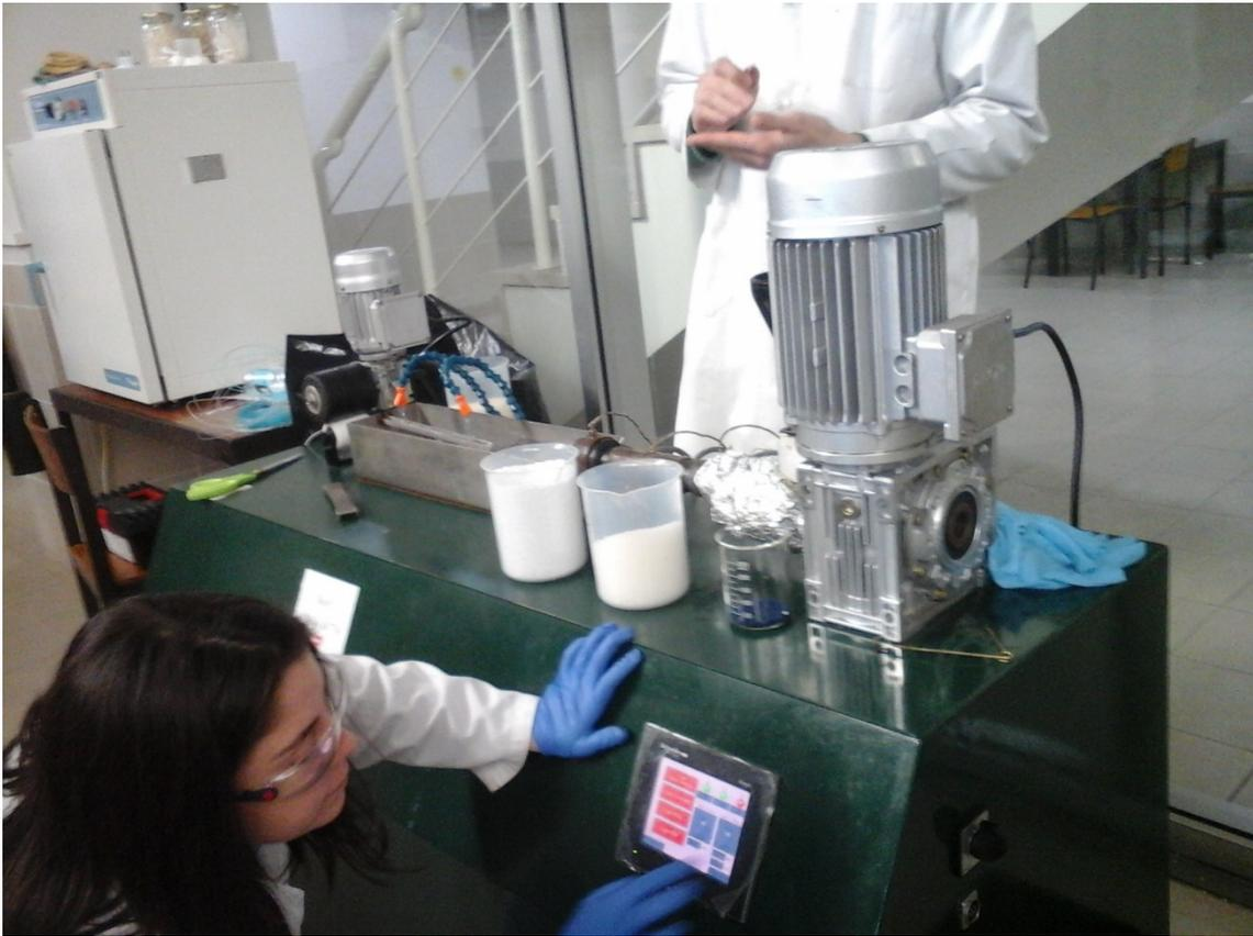
Laboratório onde os alunos observaram a técnica de extrusão. O dispositivo na imagem permite obter fio de *nylon* ou outro polímero e permite regular a sua resistência, elasticidade, etc...
