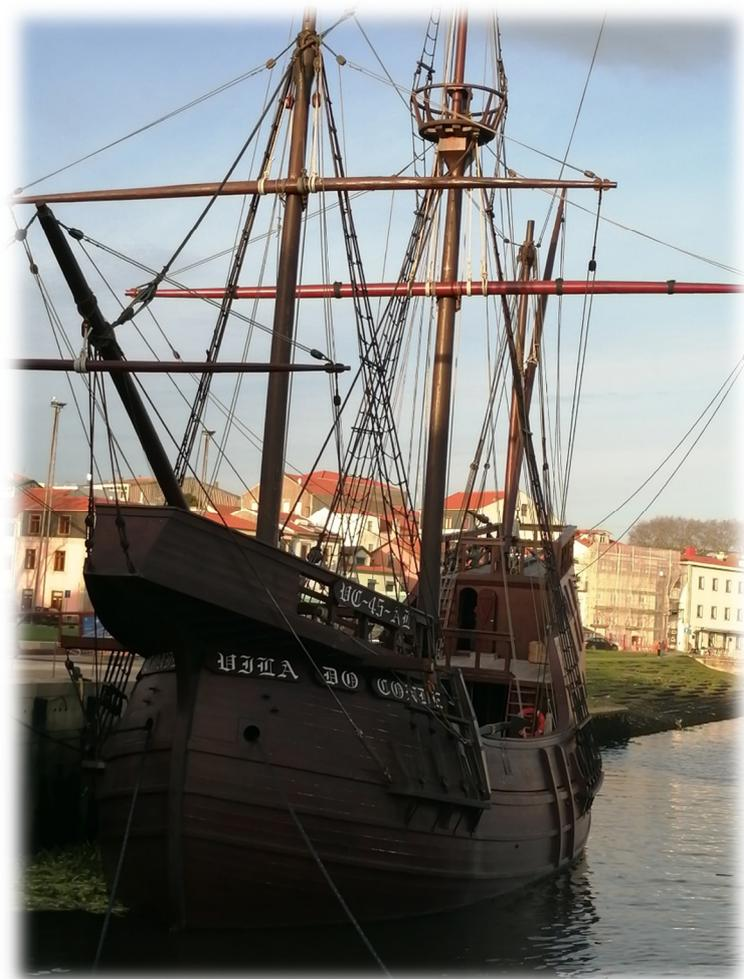
A nau portuguesa do século XVI era um navio redondo, de alto bordo, com uma relação de 3:1 entre o comprimento e a largura máxima, três ou quatro cobertas, castelos de popa e de proa, com três e dois pavimentos, respetivamente, cuja arquitetura se integra perfeitamente no casco; arvorava três mastros, o grande e o traquete com pano redondo, e o da mezena com pano latino.
